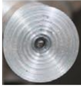
شكل رقم ٤٢ : حلقات نتيجة استخدام قلم حاد وتغذية كبيرة عند عمل التسوية
