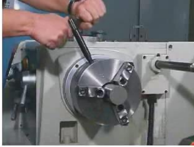
شكل رقم ٣٥: ربط الشغلة في الظرف وربطها في الظرف بدون قوة
