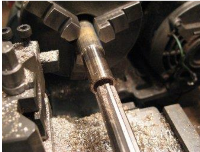
شكل رقم ١٤٧: عملية التوسيع بالبرغل reamer
