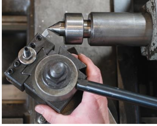
شكل رقم ٦٠: ضبط طرف رأس لقم مع مركز الذنب
