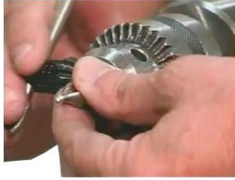
شكل رقم ٥٥: ربط الذنبة باستخدام مفتاح الظرف
