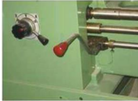
شكل رقم ٥٩: وضع ذراع التشغيل في الوسط لفص حركة الظرف عن الموتور
