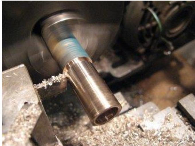
شكل رقم ١٥٠: قطع الجلبة المقلوظة
