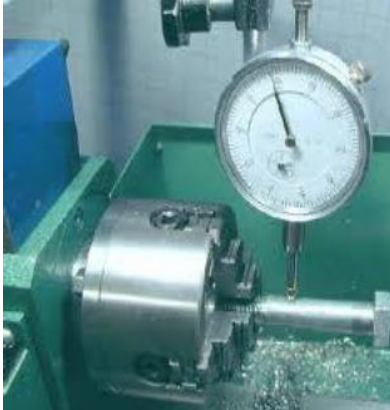
شكل رقم ٤٠: فحص مركزية الأعمدة الأسطوانية باستخدام مبيّن ساعة القياس
