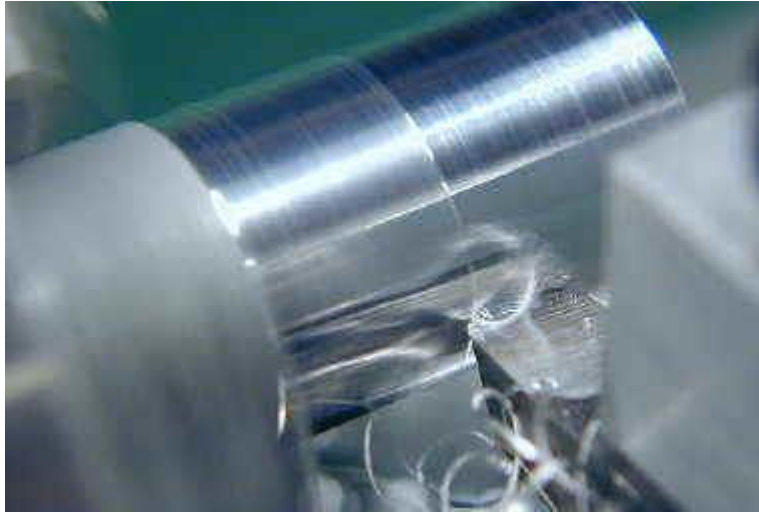
شكل رقم ٦٤: عمل مشوار التنعيم للخراطة الطولية
