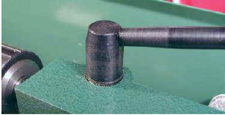
شكل رقم ٥٣: ربط ذراع تثبيت الذنب الدوارة
