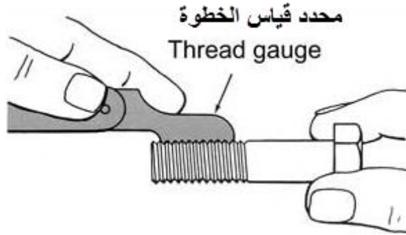
شكل رقم ١٤٣: التأكد من قيمة الخطوة
