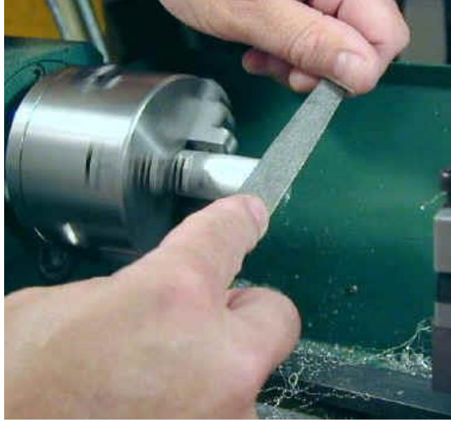
شكل رقم ٥٠: استخدام مبرد لإزالة الحواف الحادة
