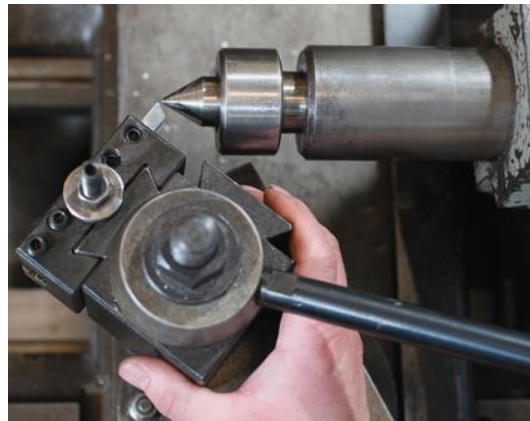
شكل رقم ٤٣ : ضبط طرف رأس لقلم مع مركز الذنب
