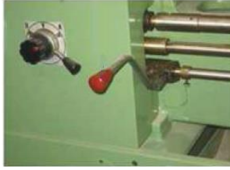
شكل رقم ٦٩: وضع ذراع التشغيل في الوسط لفص حركة الظرف عن الموتور
