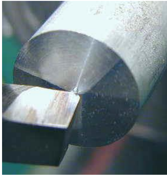
شكل رقم ٤٩: الوصول بالقلم الى مركز الشغلة
