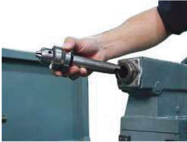
شكل رقم ٥٢: تركيب ظرف المثقاب
