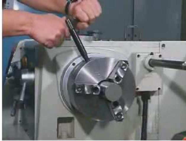
شكل رقم ٧٠: ربط الشغلة في الظرف وربطها في الظرف بدون قوة
