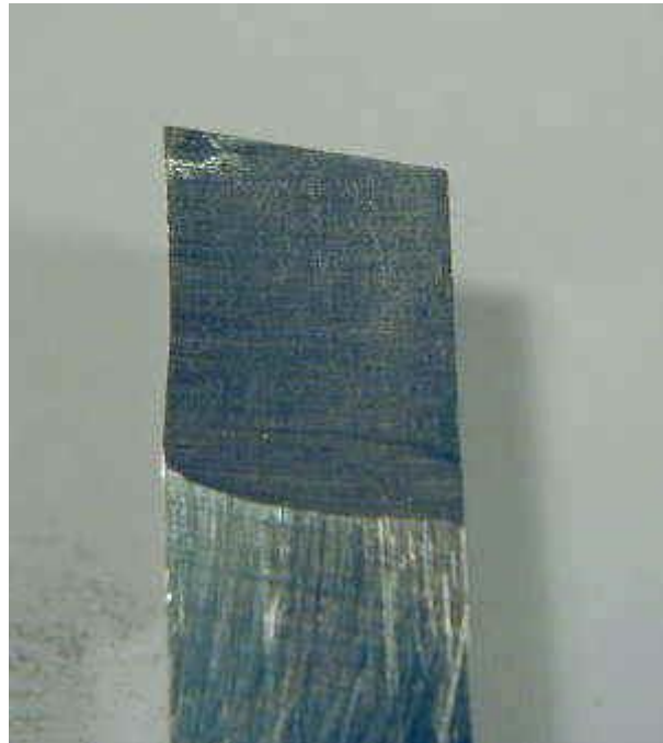
شكل رقم ٦٦: قلم ذو حواف حادة مربعة مسنون بزوايا أقل من ٩٠ درجة
