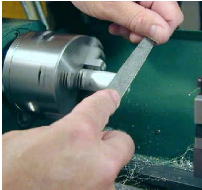
شكل رقم ٦٨: استخدام ميرد لإزالة الحواف الحادة
