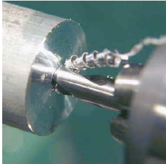
شكل رقم ٥٧: اختراق ٤/٣ طول الجزء المخروطي لبنطة العلام في الشغلة
